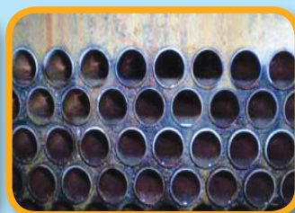
處理後散熱器表面產生磁化鐵阻止腐蝕產生
